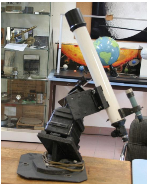
Planchette équatoriale motorisée, avec lunette de visée, permettant des poses de plusieurs minutes. A beaucoup servi à l'époque de la photographie argentique.
